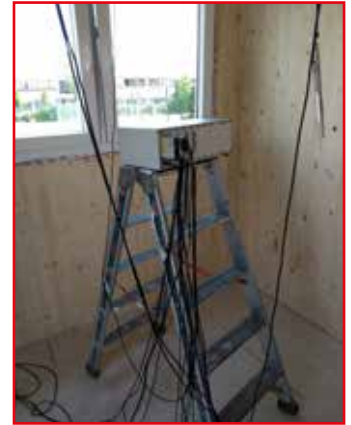
Abbildung 4: Raumluftmessung im sanierten Brettsperrholzkubus
