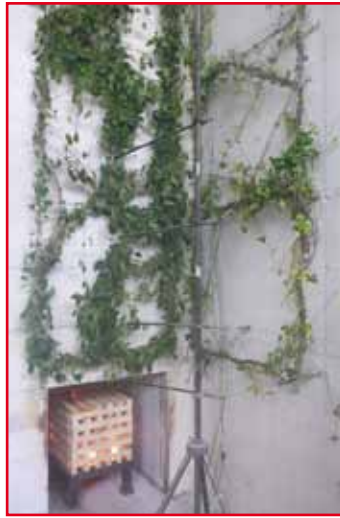
Abbildung 3: Montage der Rankhilfe am Prüfstand Abbildung 4: Montage der Pflanzen
