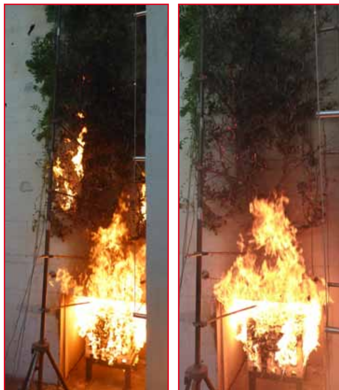
Abbildung 15: kurzzeitiger Durchzündungseffekt an der Grünfassade
