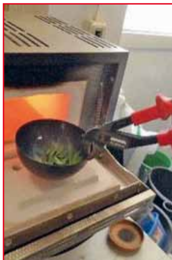
Abbildung 1: Einbringen von Pflanzenteilen in den Muffelofen [2] Abbildung 2: Mitbrand von Pflanzenteilen im Muffelofen [2]
