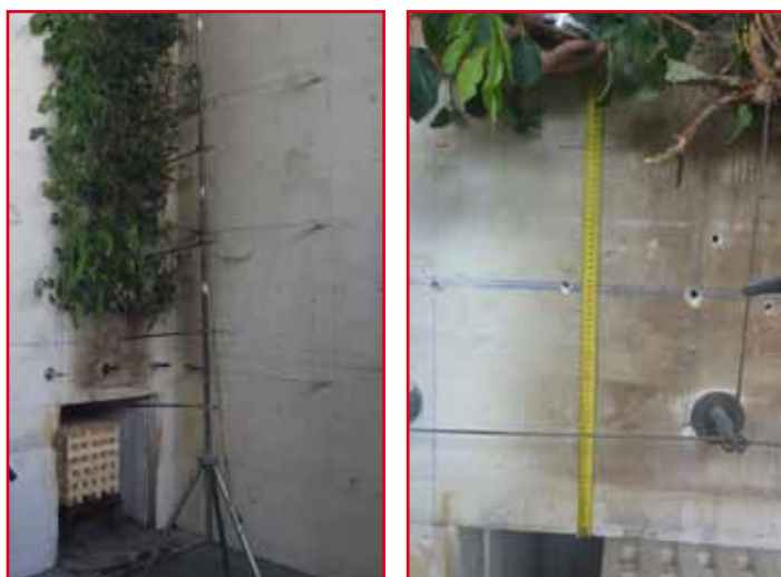
Abbildung 11: Fassadenbegrünung während des Versuches (Versuchsdauer 12 Minuten – Maximum des Krippenbrandes)
