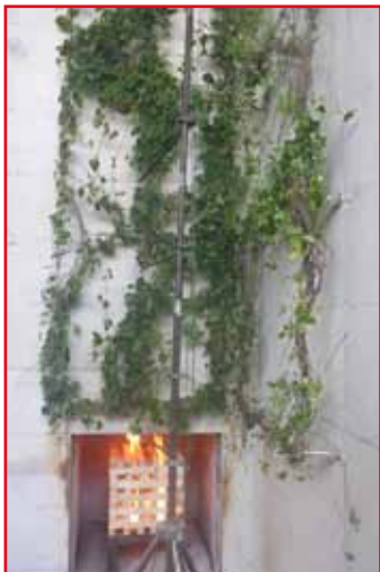
Abbildung 5: Fassadenbegrünung zu Beginn der Prüfung Abbildung 6: Durchzündungseffekt nach 9 Minuten und 5 Sekunden Versuchsdauer
