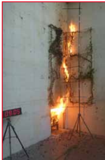
Abbildung 5: Fassadenbegrünung zu Beginn der Prüfung Abbildung 6: Durchzündungseffekt nach 9 Minuten und 5 Sekunden Versuchsdauer
