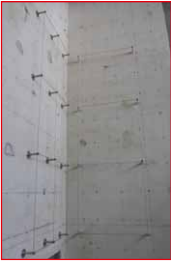
Abbildung 3: Montage der Rankhilfe am Prüfstand Abbildung 4: Montage der Pflanzen
