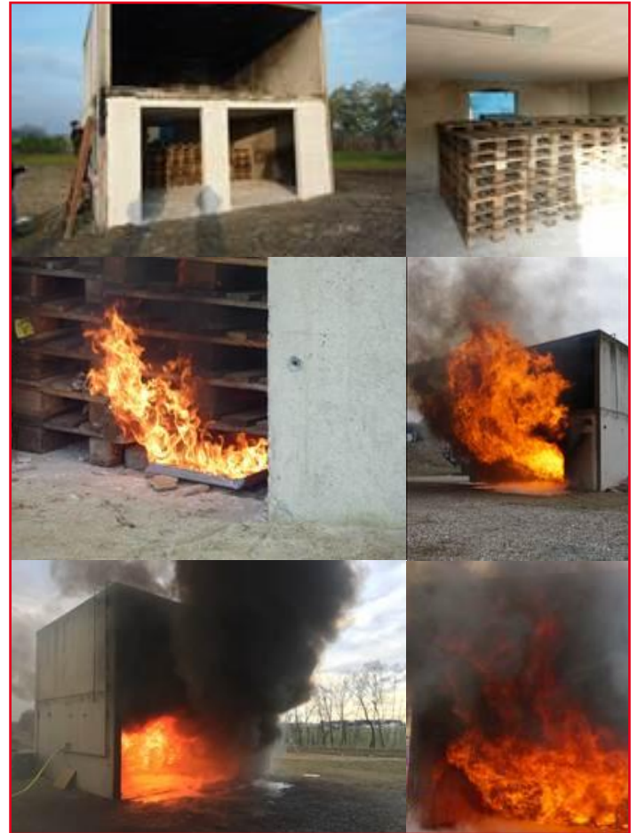
Die Fotos zeigen den Aufbau und die Durchführung einer Naturbrandversuchsreihe der ADSUM Brandschutz- & Sicherheitsconsult GmbH.
