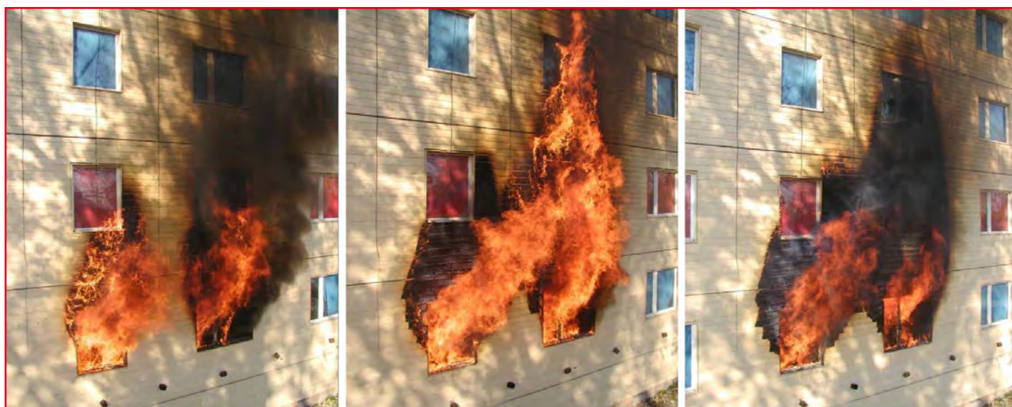
Naturbrandversuch an Holzfassade V2 – Versuchsverlauf (Quelle: © MFPA Leipzig) 7. Prüfminute: Durchzündung
