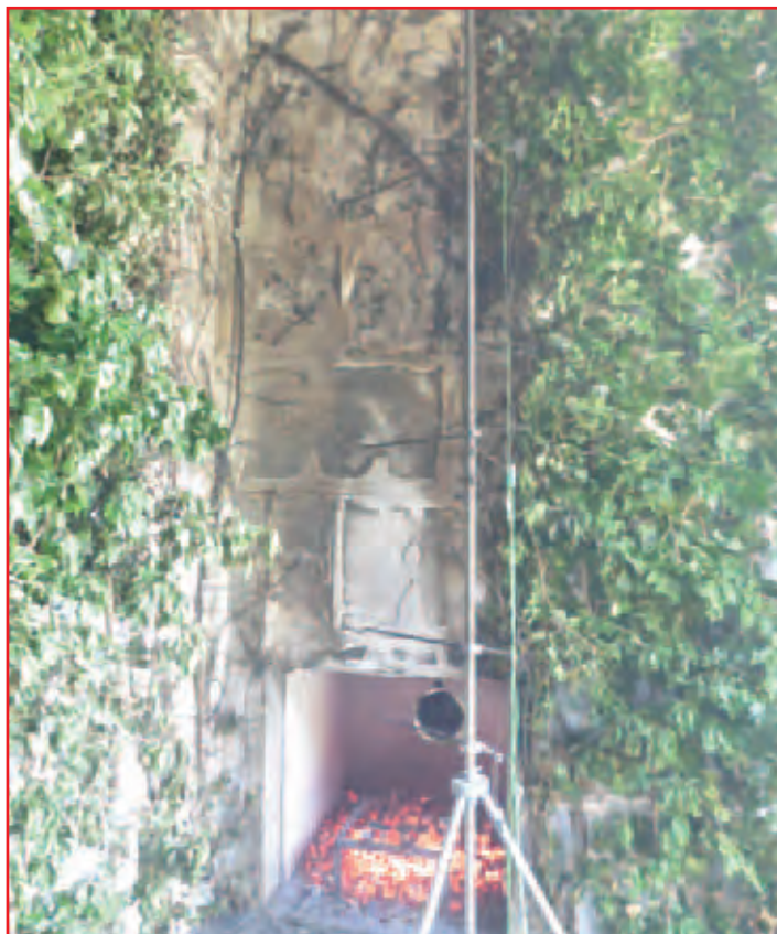
Abb 3: Fassadenbegrünung zum Ende der Prüfung.
