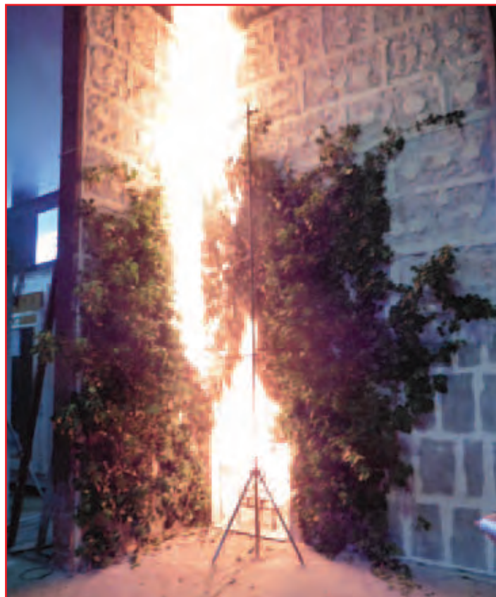
Abb 2: kurzzeitige vertikale Brandweiterleitung während der Brandprüfung.
