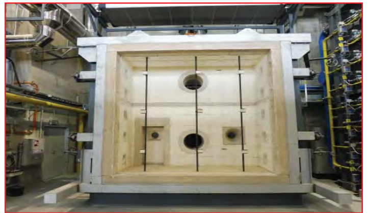
Bild 5 (Quelle MA 39): Vertikalprüföfen 3 m x 3 m
