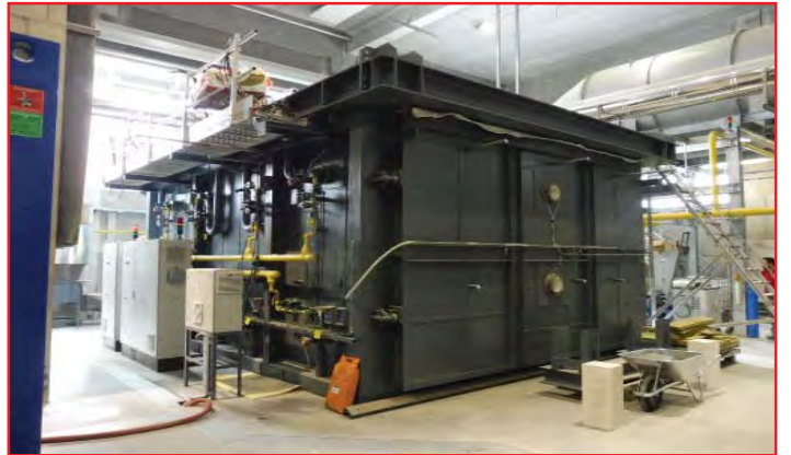
Bild 7 (Quelle MA 39): Horizontalprüföfen Außenansicht
