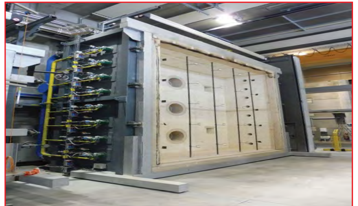
Bild 6 (Quelle MA 39): Vertikalprüföfen 5 m x 5 m
