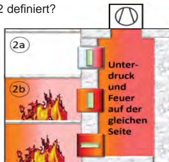
Bild 2: Entrauchung mit einem Entrauchungsschacht.
