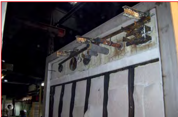
Abb. 5: Durchbiegung der Leichtwand
