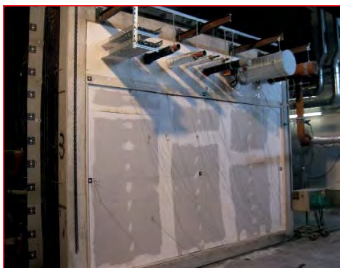
Abb 6: Feuerzugewandte Seite des Versuchsaufbaus nach Versuche
