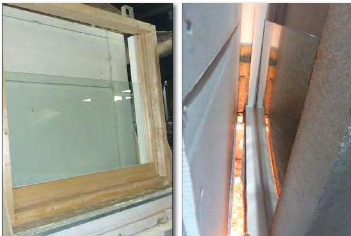
Abb. 8: Aufbau des Brandschutzschildes am Prüffofen (Quelle: MA 39)
