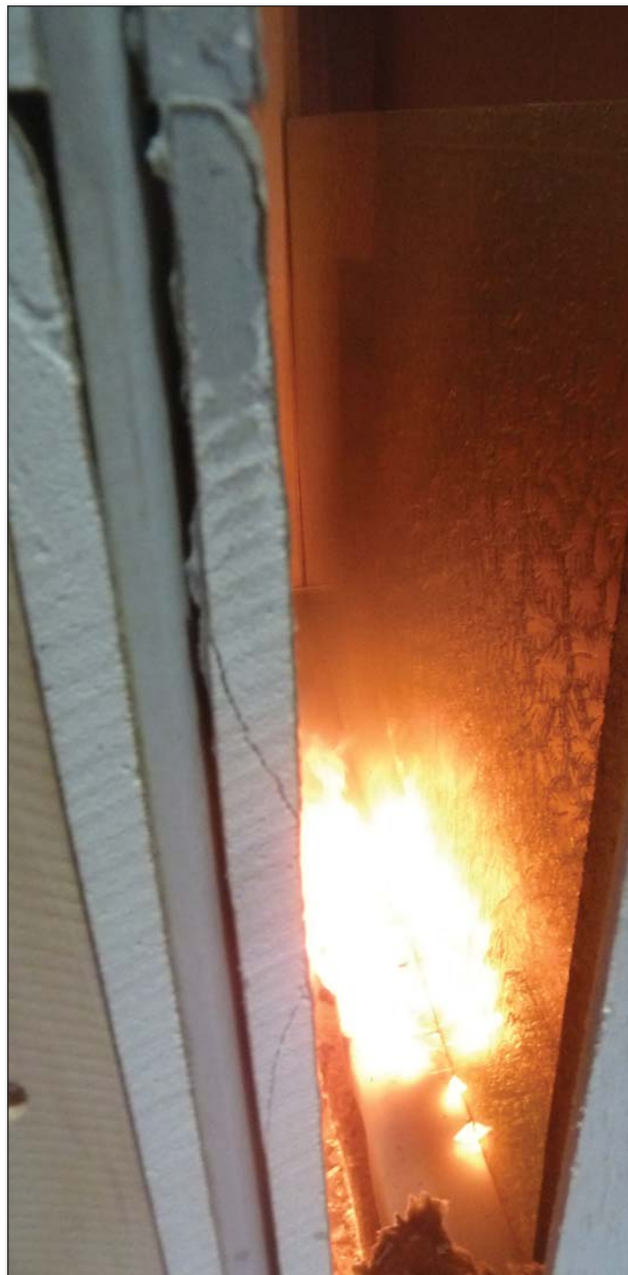
Abb. 11: Prüfkörper zum Ende der Prüfung – kein Herabfallen erkennbar (Quelle: MA 39)
