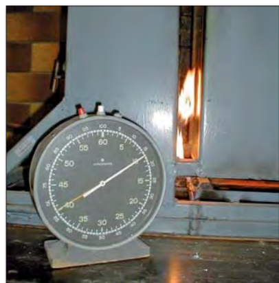
Abbildung 1: Prüfung im Schlytertest nach ÖNORM A 3800-1
