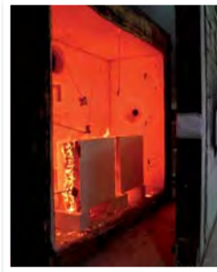
Abbildung 7: Prüfkörper nach Entfernen der Blindwand nach 90 Minuten Prüfdauer
