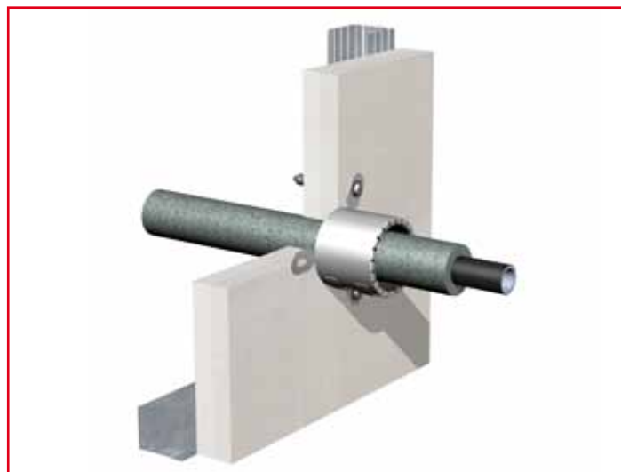
RORCOL AV60 aufgesetzt auf 2 x 20 mm Schachtwand zur Abschottung von Aluverbundrohren
