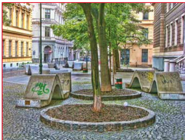
Bild 5: „Stillgelegtes“ Straßenstück vor einer öffentlichen Schule. Durch die Betonformkörper, den Pflanzenbewuchs und die Radständer ist allerdings ein Aufstellen von Feuerwehr-Drehleitern nicht mehr möglich.
