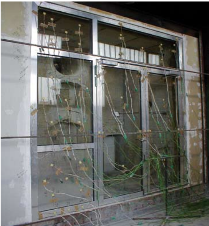
Prüfung eines verglasten Brandschutzportales nach europäischen Prüfnormen.
