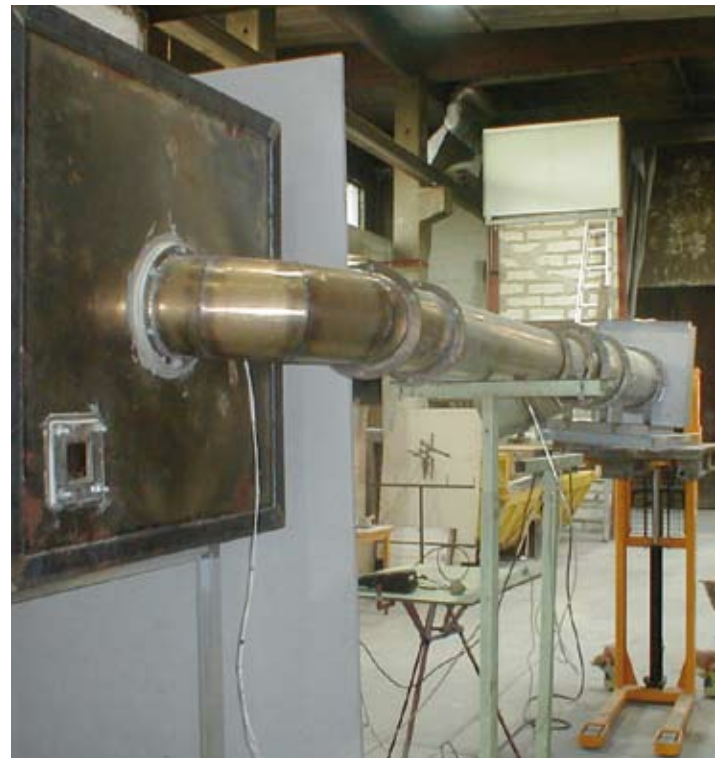
Prüfanordnung für Brandschutzklappen nach europäischer Normierung.
