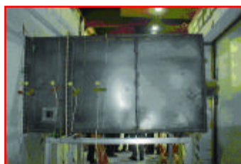
Unterdruckkasten auf der brandabgekehrten Seite bei Prüfung gemäß ÖNORM EN 1366-2
