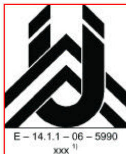
Bild 4: Beispiel für ein Einbauzeichen (Bildzeichen samt zusätzlicher Angaben) (1)... Kurzbezeichnung der das Zeugnis ausstellenden Stelle)
